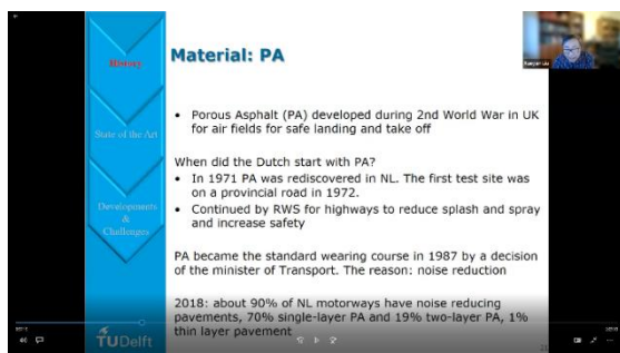
Gambar 5. Topik mengenai implementasi aspal pori di Belanda pada seminar Asphalt Day 2023 (27 Januari 2023)
