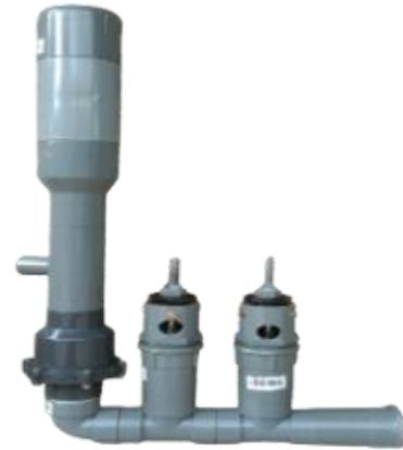
**Gambar 117. Pompa hidram siap diimplementasi**
