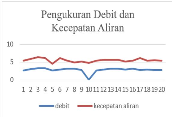
Gambar 51. Data debit dan kecepatan aliran air
