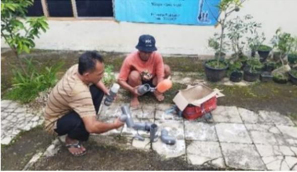
**Gambar 19. Perakitan pompa hidram**
