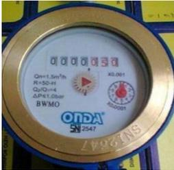
Gambar 4. Alat Pencatat Meter Air
