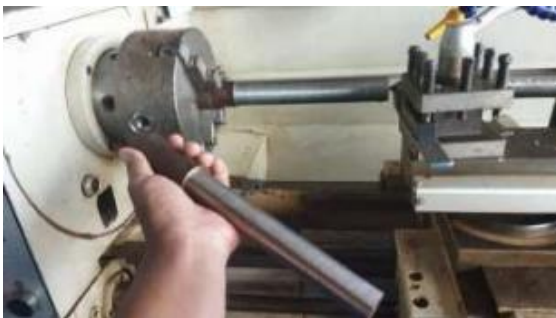
Gambar 14. Hasil Pembubutan Shaft Pipa 1/4" Sch 40 (Pipa Hitam)
