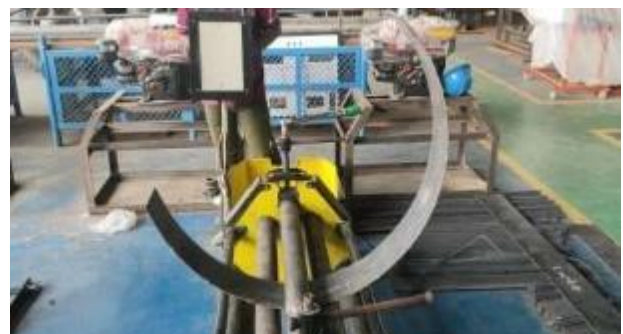
Gambar 7. Penekukan Awal Plat Besi Pembuatan Roda
