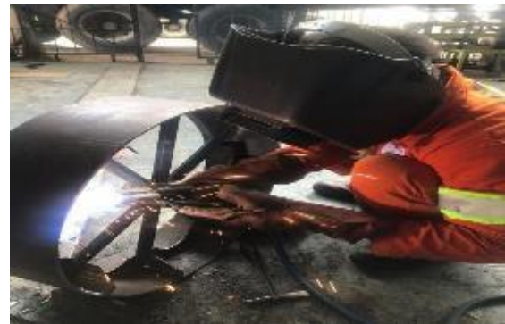
Gambar 16. Pengelasan Jari-Jari Roda
