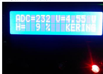
Gambar 3.3 Hasil penelitian alat dengan multimeter pada tanah kering kedua
