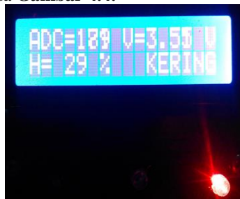
Gambar 3.4 Hasil penelitian alat dengan multimeter pada tanah kering ketiga
