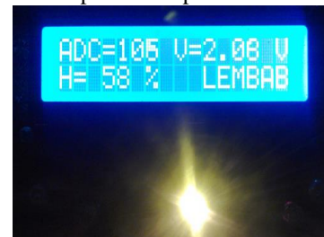
Gambar 3.6 Hasil penelitian alat dengan multimeter pada tanah lembab kedua
