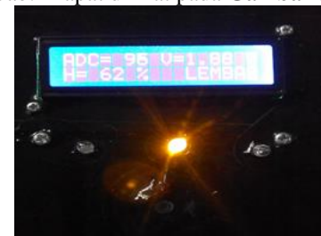
Gambar 3.7 Hasil penelitian alat dengan multimeter pada tanah lembab ketiga
